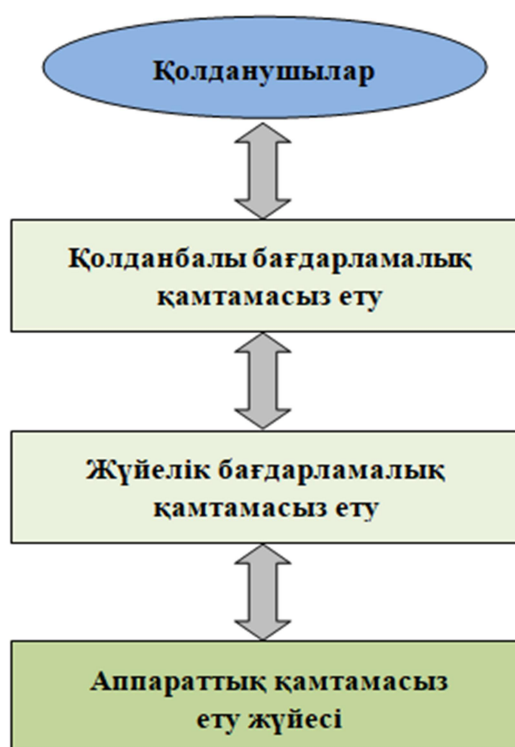
2.5-Сурет. Аппараттық жүйе, жүйелік бағдарламалық жасақтама, қолданбалы бағдарламалық жасақтама және пайдаланушылар арасындағы өзара әрекеттесу
